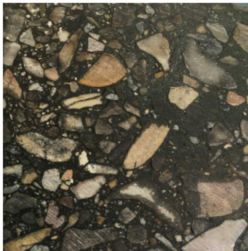
**El BASEBIT, se fabrica con granulometría 0/14 y 0/20 en función del espesor de la capa a emplear:**
